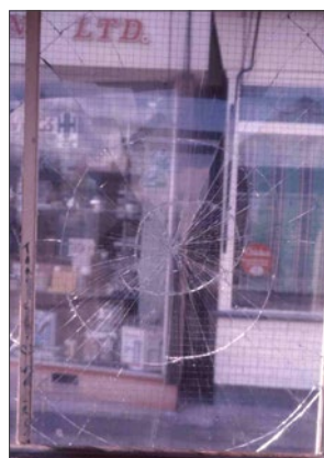
Padrões de fratura em vidro de ponto de ônibus depois de um tijolo ter sido jogado nele. (Foto por Peter Kennett)
