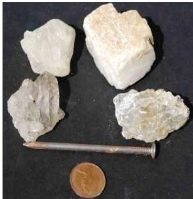
Dureza: fluorita, calcita, gipsita e quartzo com um prego de aço e uma moeda de cobre
