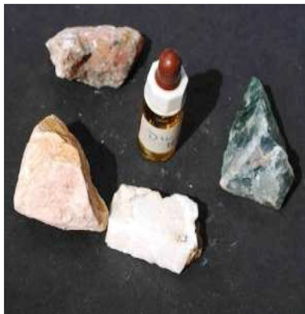
Teste de ácido: gipsita, fluorita, calcita, bário e um frasco contendo gotas de ácido clorídrico diluído. Todas as fotos: Peter Kennett
