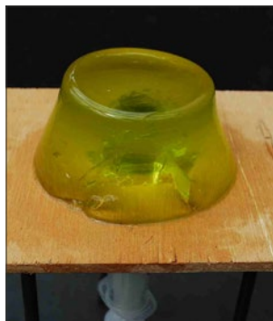
"Caldeira de subsidência", depois de puxar o êmbolo duas ou três vezes. Uma fratura radial também pode ser vista, produzida quando o êmbolo for empurrado.
