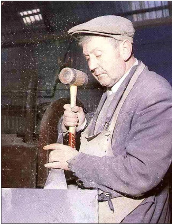
Um artesão galês separando ardósia (como se estivesse separando os fósforos alinhados com uma régua). Foto: J.W. Greaves & Sons, Blaenau Ffestiniog.
