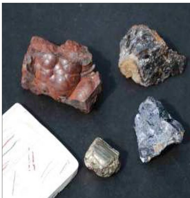
Traço: hematita, esfalerita, galena e pirita com uma placa de traço.
